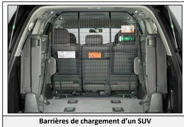
6.6.3. Si le véhicule est équipé d'un auvent en fibre de verre ou en plastique, une barrière de chargement doit toujours être installée à l'intérieur à l'avant de l'auvent.
